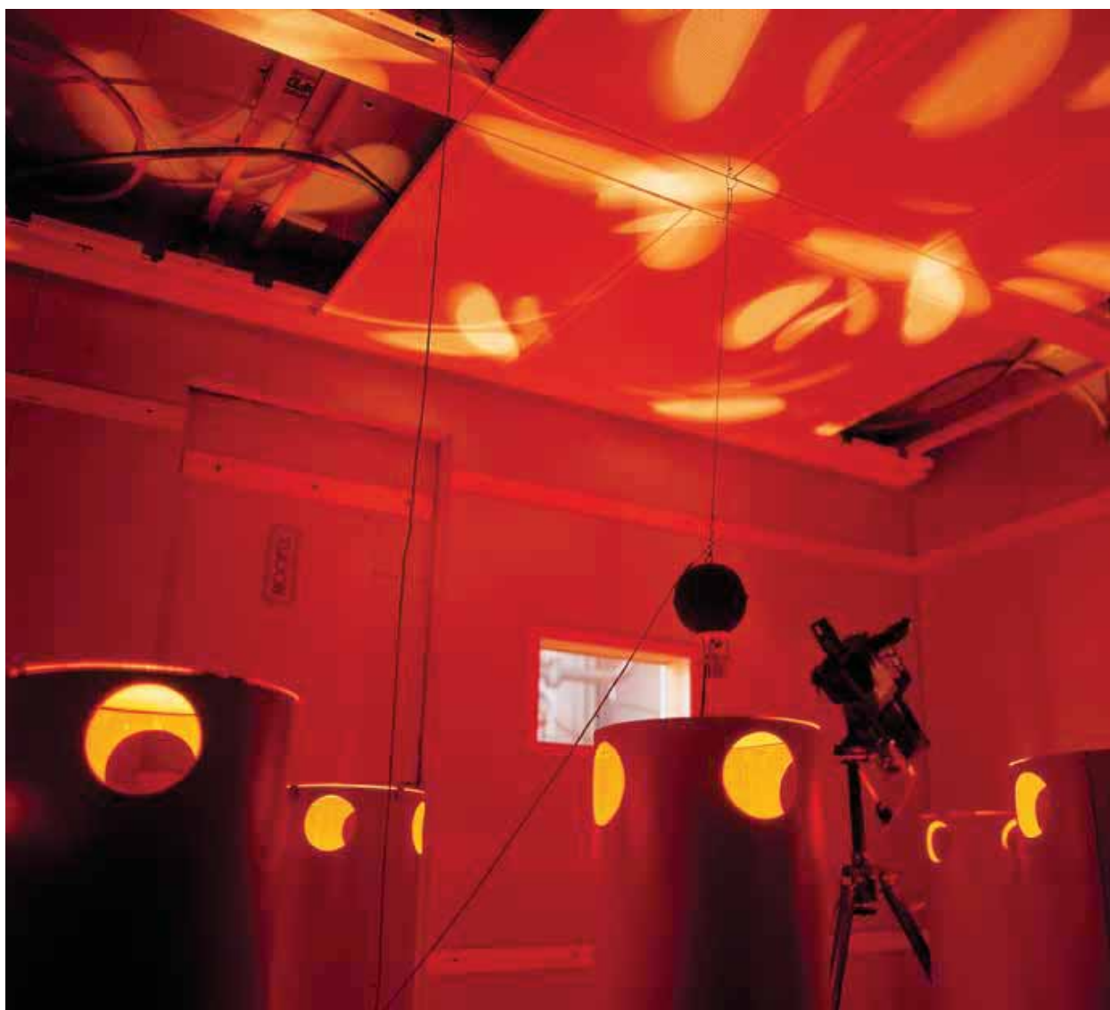
图4.1 嘉科米尼实验室：恒温室的细节根据EN 14240标准设定
